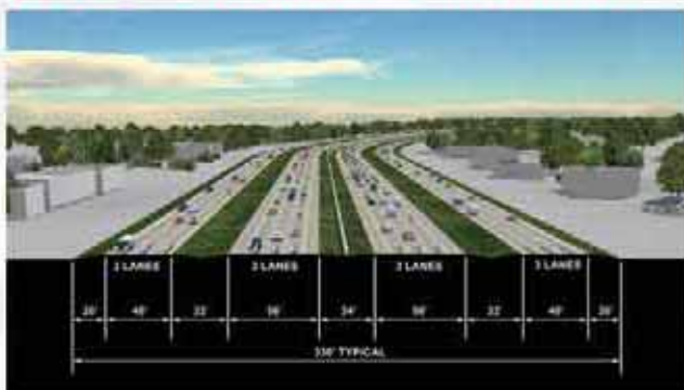
Una carretera de seis carriles en la US 80 desde Belt Line Road hasta la FM 460.
